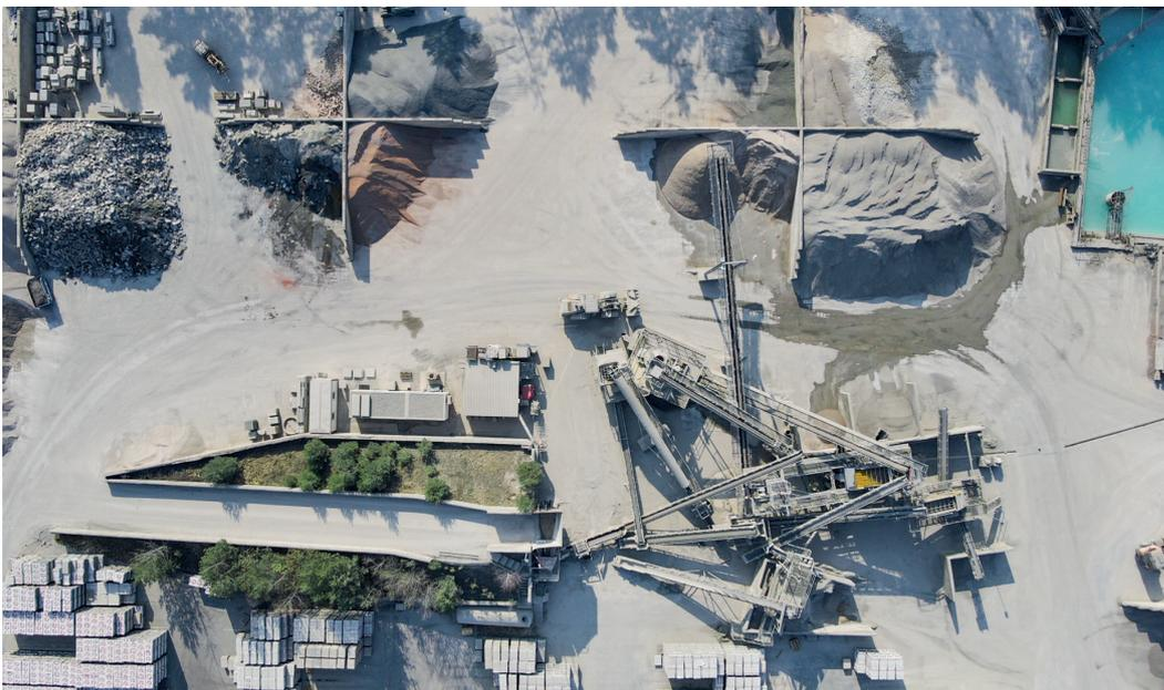
Mit der Recycling-Anlage auf dem Werksgelände stellt GODELMANN sein Recyclingmaterial für neue Steine selbst her. Die Ausgangsmaterialien werden in verschiedene Körnungen gebrochen und für die Produktion gelagert. Jährlich werden so 50.000 Tonnen Primärrohstoffe eingespart.
