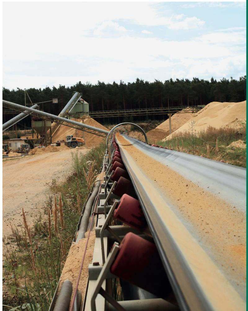
In unserer Sandgrube wird das abgebaute Material per Förderband transportiert, um die CO<sub>2</sub>-Emissionen gering zu halten.
