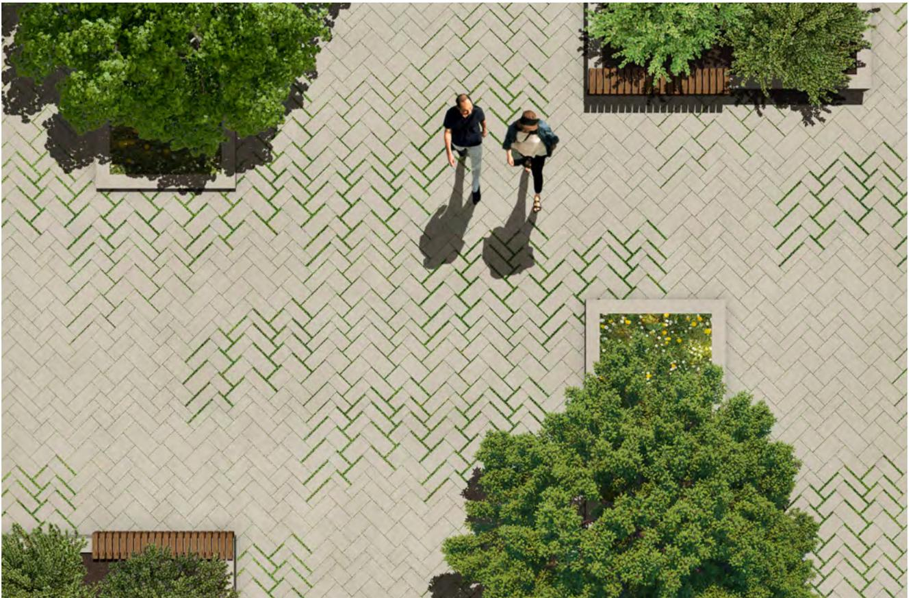
Schwammstadt Variante 4.3: Mehrsteinsystem Typ AD, Typ AD 13 mm liner 1-1 und Typ AD 26 mm liner 1-1, Fischgrätverband
