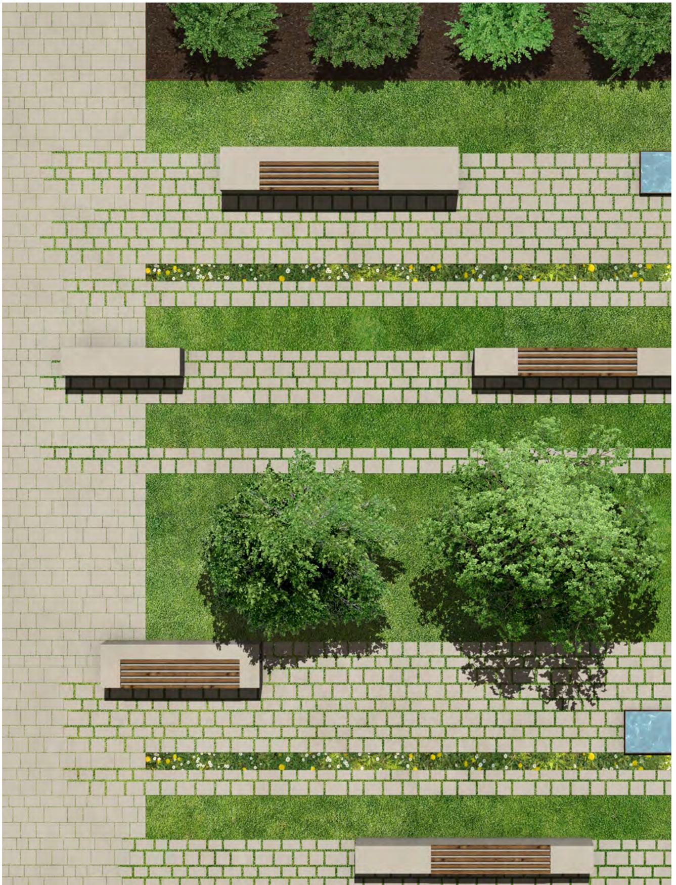
Schwammstadt Variante 3.2: Mehrsteinsystem Typ AH und Typ AI 30 mm gap, Reihenverband
