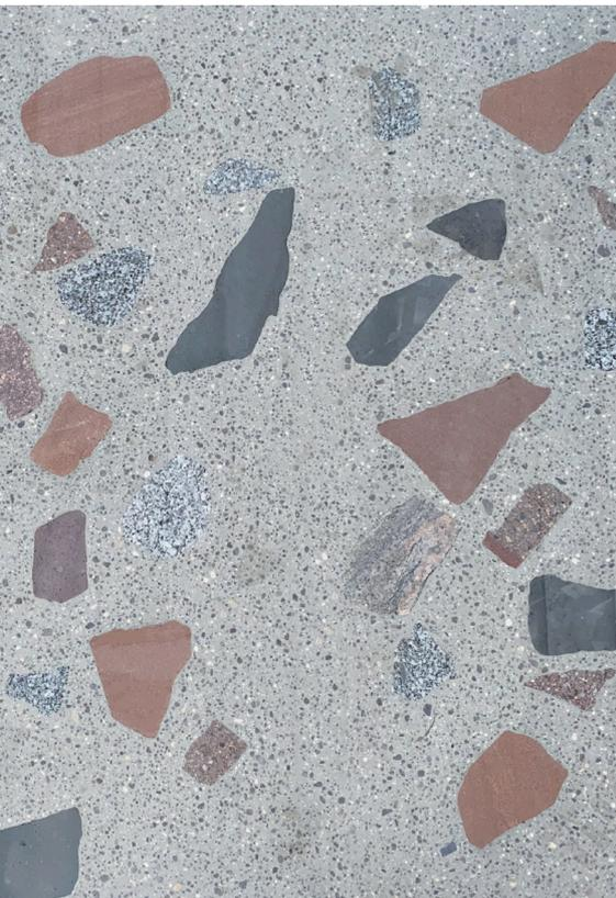
Altes Sandstein- und Granitpflaster wurde in unserer Hochwert-Recyclinganlage aufbereitet und in unserer Manufaktur weiterverarbeitet. Entstanden sind wunderschöne großformatige Platten mit geschliffener Oberfläche und sichtbar gemachtem Recyclingmaterial für **„Der Andere Park“** in Heidelberg.
