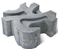
**SCADA Rasenornament** kombiniert fantasievolle Gestaltung mit ökologischer Funktion und kann zu über 30 % begrünt oder mit Splitt ausgefugt werden. Damit liegt der Abflussbeiwert bei 0,15. Die niederländische Designerin Fien Dekker entwarf die außergewöhnliche Form, die 2019 sogar mit dem Red Dot Design Award ausgezeichnet wurde. Egal wie der Stein beim Verlegen gedreht wird, es entsteht ein spielerisch unbeschwertes Flächenornament.
