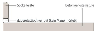
Verlegung nur auf zwei Mörtelstreifen am äußersten Ende der Betonwerksteinstufen.
