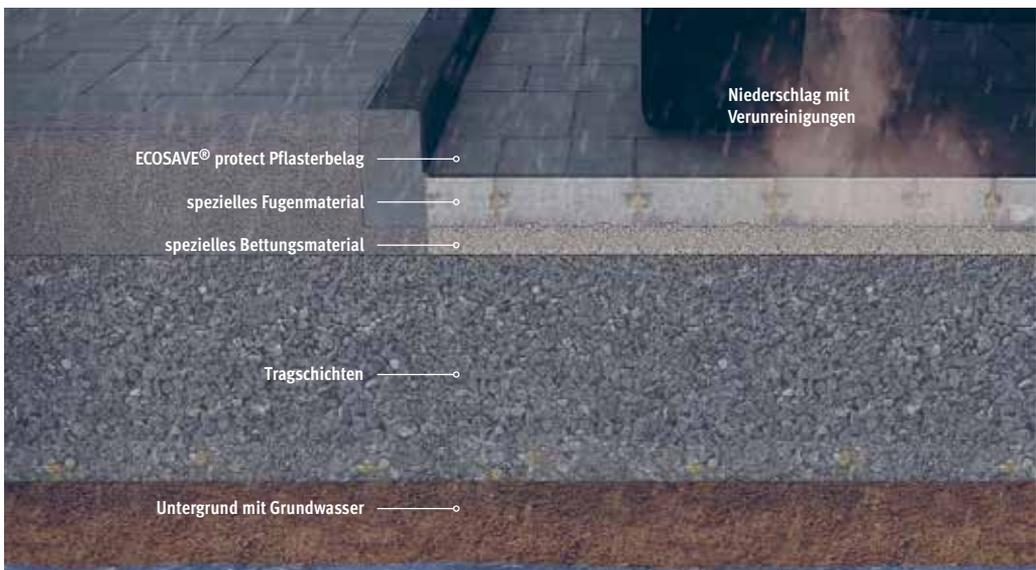
Auf Verkehrsflächen, die mit **ECOSAVE® protect** befestigt werden, ist die Versickerung des Niederschlagswassers dauerhaft gewährleistet, da die Pflasterbeläge nachweislich regenerierbar sind. Damit liegt der Abflussbeiwert wie bei nicht versiegelten Flächen (z. B. Rasen) bei 0,0 (siehe Tabelle Rechenbeispiel unter „2.5 Einsparungen“ auf Seite 10).
