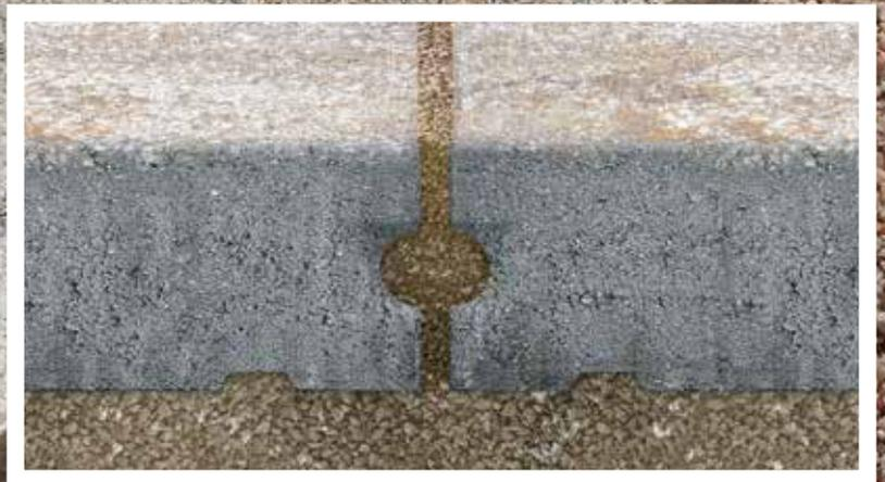
**DRAINSTON protect:** Das Wasser versickert über die Fugen und die Sickerkanäle am Stein
