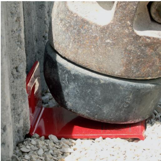
Abb. 88: Der Verschi 485/50 wird eingeschlagen.
