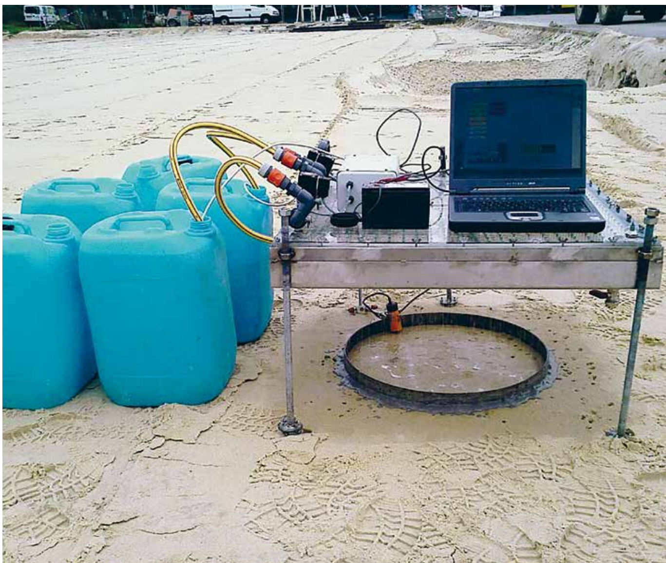
Abb. 14: Prüfung der Wasserdurchlässigkeit mit dem Tropfinfiltrrometer
