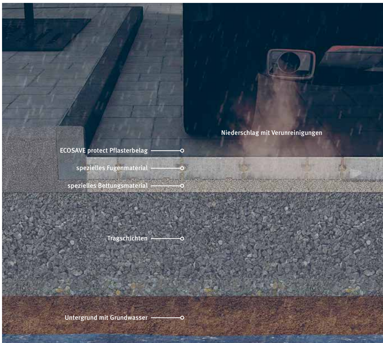
Abb. 15: Der Grundwasserabstand muss eingehalten werden
